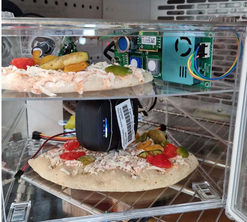
Exsikkator mit der eingebauter Sensortechnik und dem Anwendungsfall (frische Pizza)
