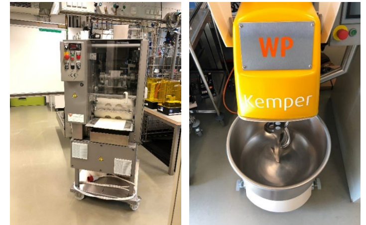
Leihgaben des Projektpartners - WP Kemper links: Teigteiler und Rundwirker, rechts: Spiralmixer „Mobile“ SP 25
